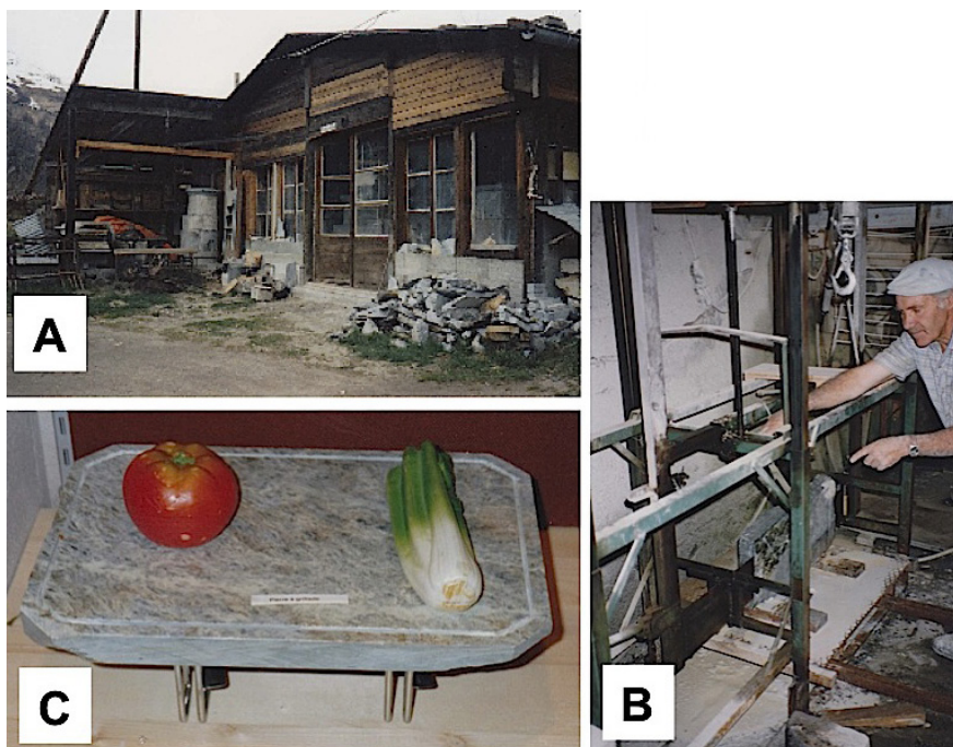
Fig. 10 : A, B. Atelier de poêlier de Laurent Pralong à Evolène en 1993. La photo à droite montre la scie qu'il a construite pour scier des dalles de fourneau. C. Plaque de pierre ollaire pour griller la viande, fabriquée par L. Pralong et exposée au Centre de géologie et de glaciologie des Haudères. Clichés : H.-R. Pfeifer.
