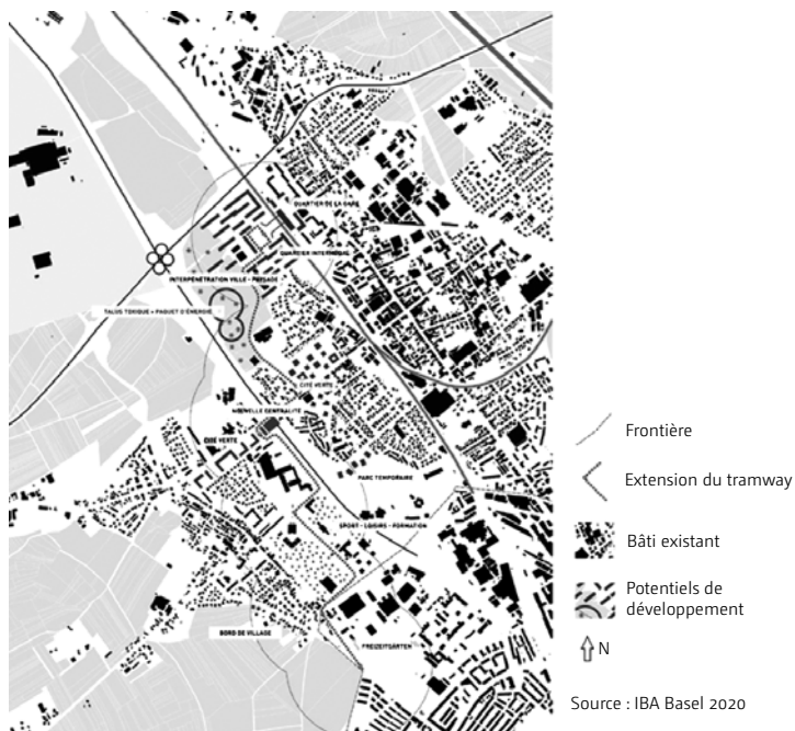
Figure 3 : Plan de l'extension de la ligne 3 de Bâle vers Saint-Louis (Source : IBA Basel 2020)
